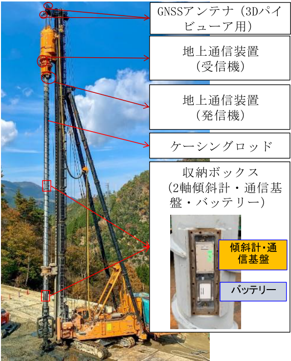
図－4 大深度先端位置計測システムを搭載した DCS 機
