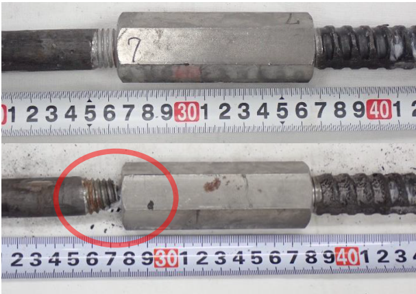
写真-10 継手外観の例 No. 1 (上:試験前, 下:試験後)
