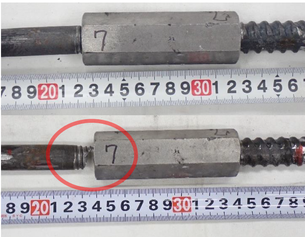
写真-11 継手外観の例 No. 2 (上:試験前, 下:試験後)
