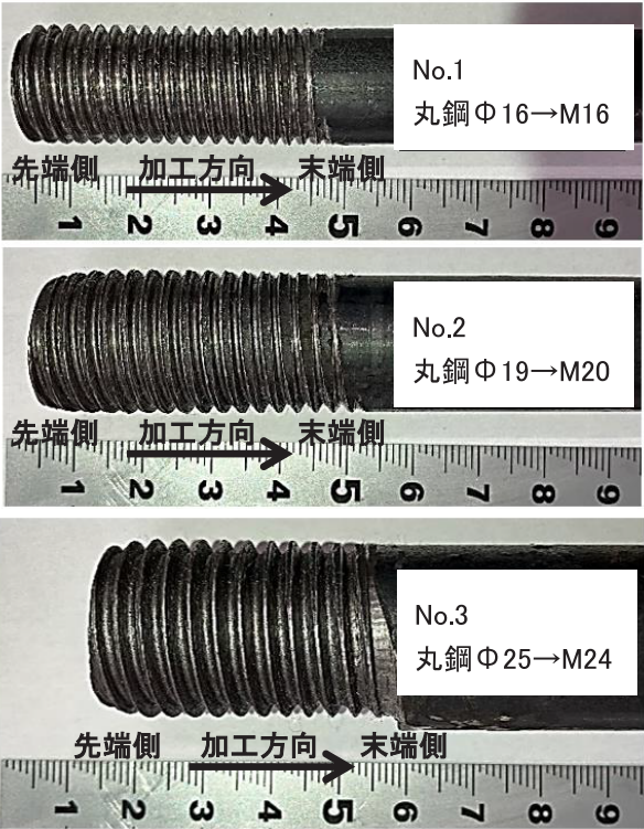
写真－1 丸鋼をおねじ加工した外観
