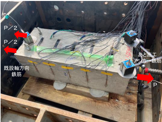
写真－2 重ね継手引張試験実施状況
