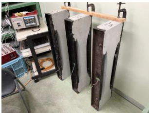
写真－５ 拘束ひび割れ試験体の気中養生の様子 (20℃ 60%環境)
