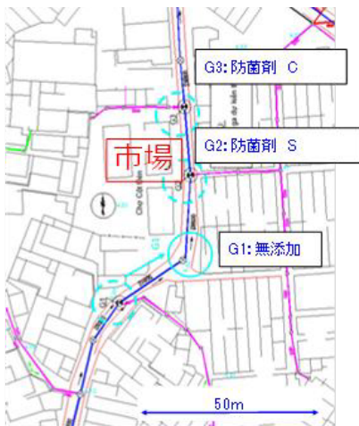
図－7 耐食性マンホール布設箇所
