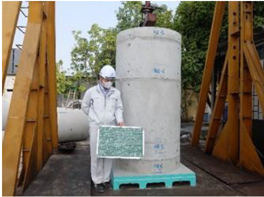
写真－3 軸方向載荷試験状況（北部材料）
