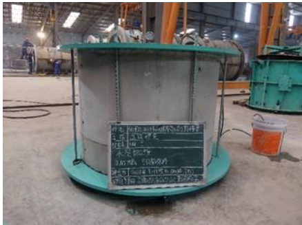
写真-5 水密試験状況 (南部材料)
