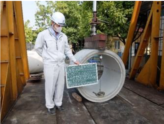
写真－4 側方曲げ強さ試験状況（南部材料）
