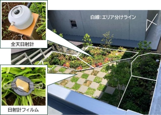
写真-4 日射計測方法
