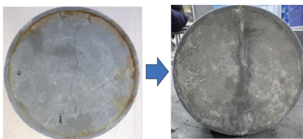
写真-2 漏水試験前後の試験体底面の状況
