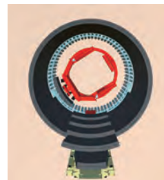
スマートシールド®によるシールド施工管理 上：地盤中にシールドの現在位置を表示 左：セグメントの組立状況をリアルタイムに表示
